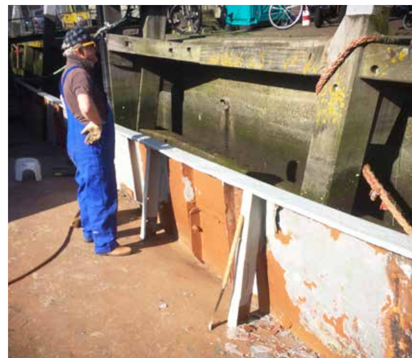
Dikke lagen verf en roest worden van de verschan-sing afgebikt
