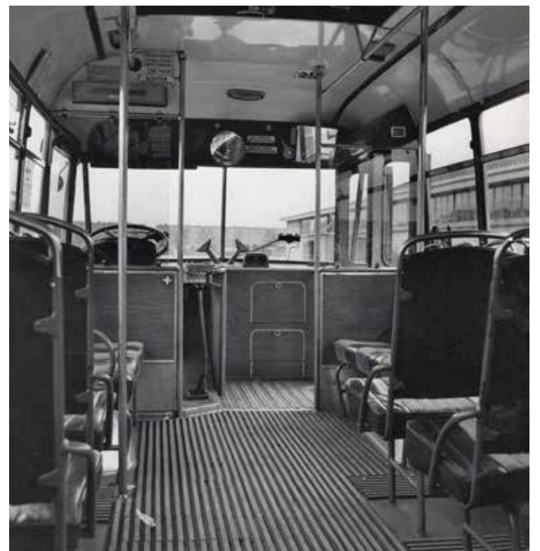
Interieur van de Kromhoutbus 208 met de motor onder de vloer
